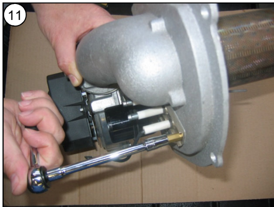
Zünd- und Ionisationselektrodenblock ausbauen, Brenner auf Verunreinigung und Beschädigung prüfen
