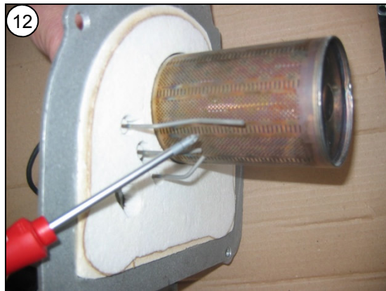
Elektrodenblock, Brennerisolierung und Brenner auf Abnutzung und Lage prüfen! Genaue Daten siehe unter 3.4.0 f.f.
