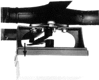
Abb. 5.1 Motorhebel und Mischergriff (Draufsicht)
