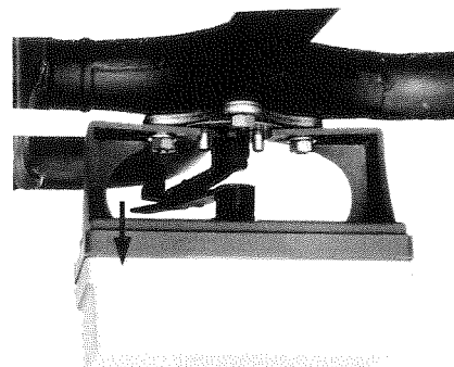
Abb. 5.1 Motorhebel und Mischergriff (Draufsicht)
