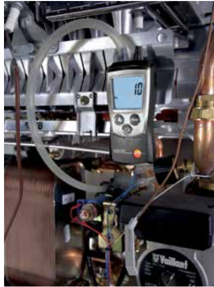
Abb. 9: Ablesen von Gasanschluss- und Düsendruck am testo 510
