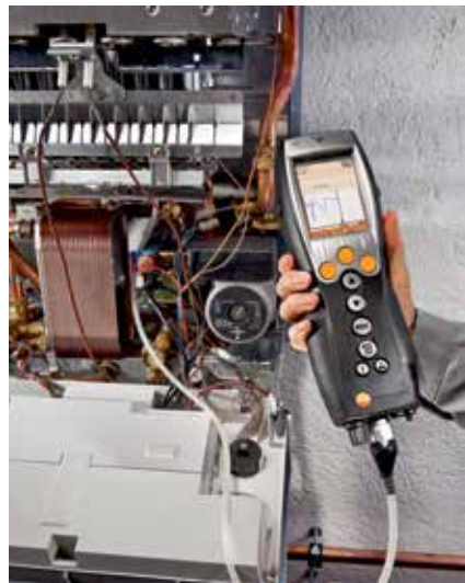
Abb. 15: Mit dem Abgas-Analysegerät testo 330 können neben den Abgas-Messwerten auch schnell und präzise Absolut- und Differenzdrücke gemessen werden.
