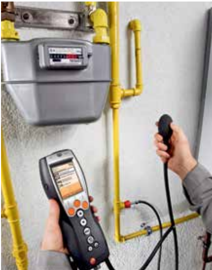
Abb. 19: Mit einem Rauchgasanalysegerät lassen sich einfach und präzise alle wichtigen Mess- und Berechnungswerte ermitteln.
