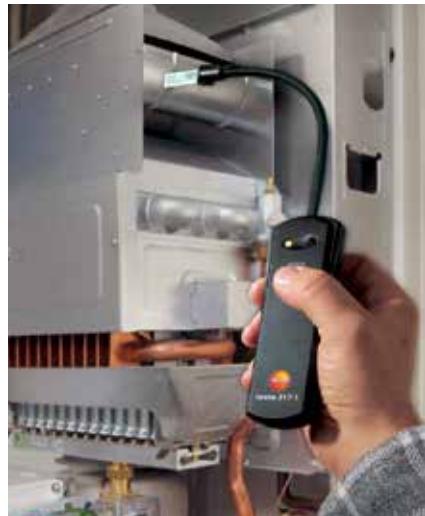
Abb. 17: Anwendung des Rückstaumelders testo 317-1
