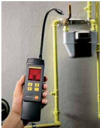
Abb. 20: Lecksuche an Gasleitungen mit dem testo 316-2
