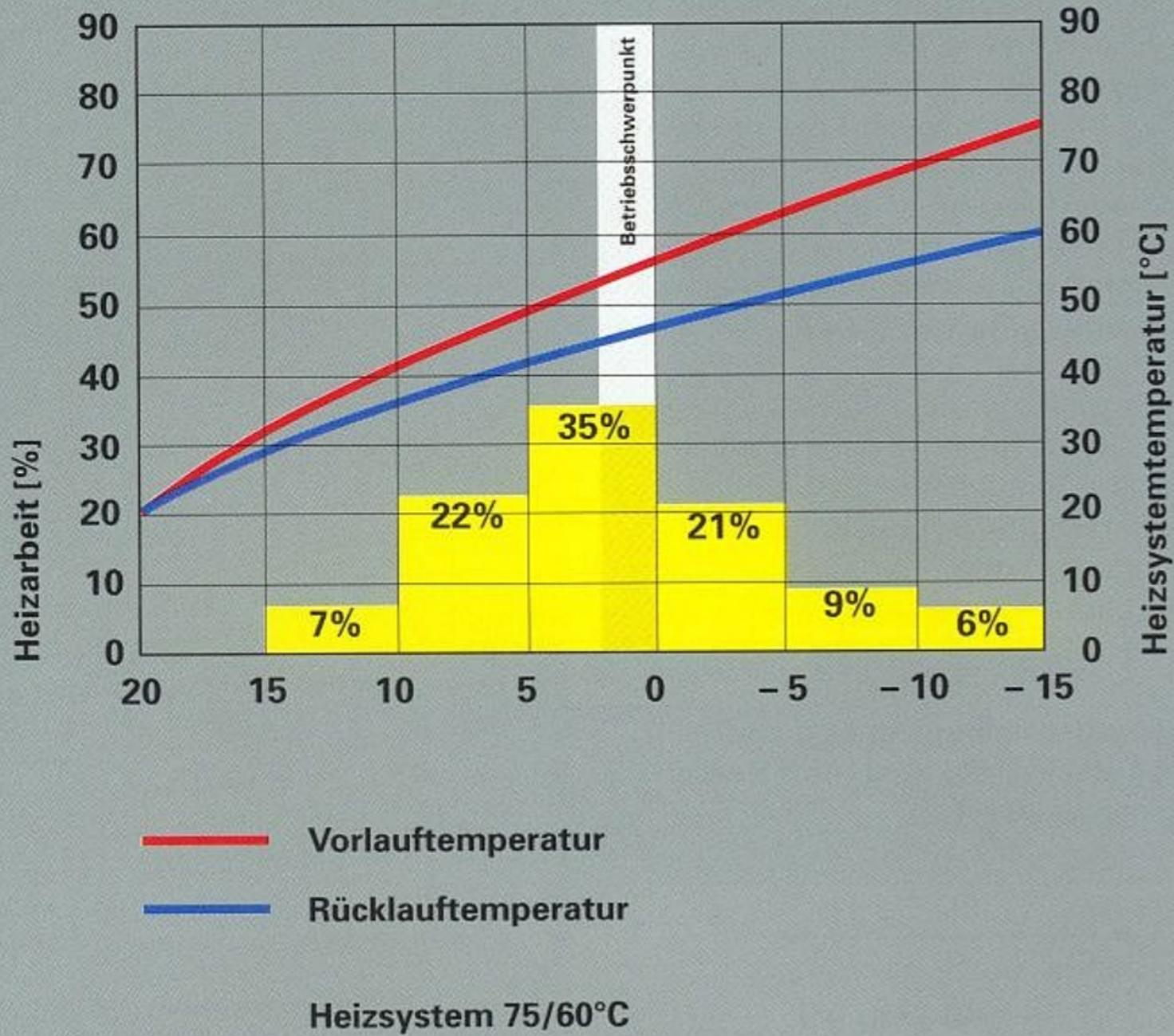
[Quelle: Viessmann- Aufteilung der Jahresheizarbeit auf unterschiedliche Außentemperaturen bei einem Heizkörpersystem.]
