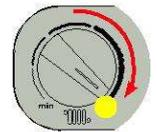
Bei der aktiven Verbrennungskalibrierungsfunktion ist es nicht möglich, mit dem Heizwassertemperaturwähler die Kesselleistung (Gebläsedrehzahl) zu ändern, wie bei der Schornsteinfegerfunktion.
