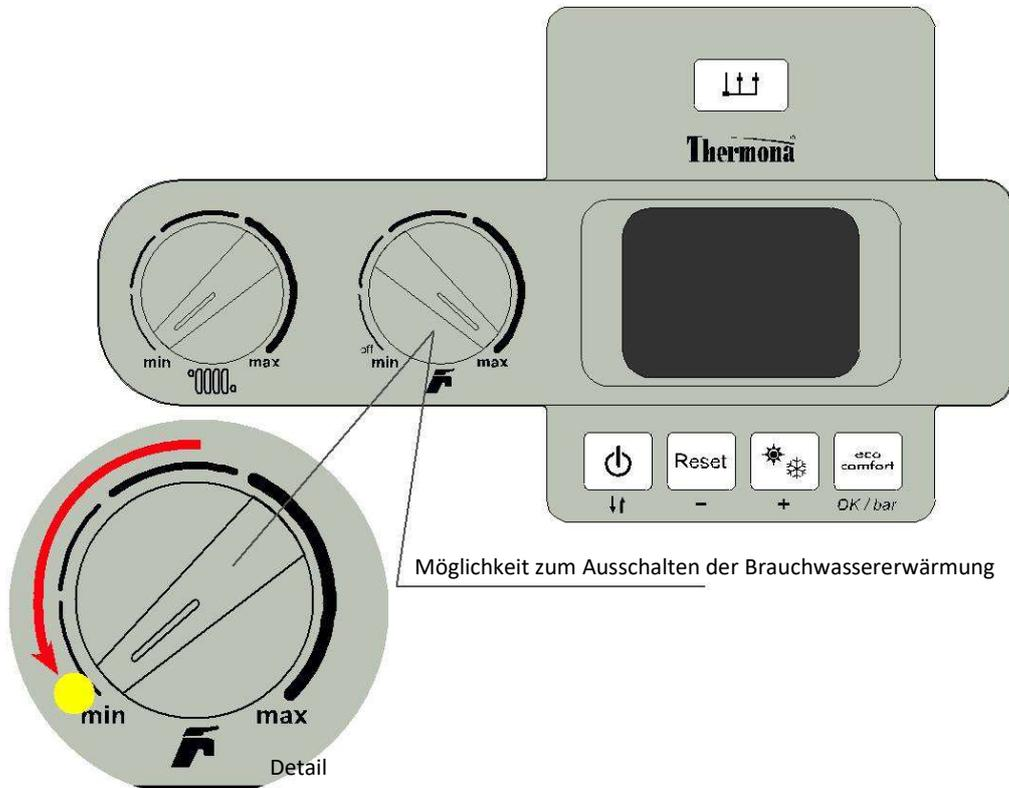
**LCD-Display** – Anzeige der Betriebsparameter des Kessels
