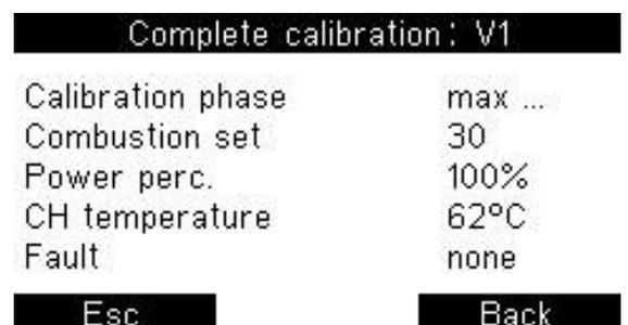
Nach Erreichen (max. ok auf dem Display wird angezeigt) ist es möglich: Wenn die Kesselverbrennung den Anforderungen entspricht Bestätigen Sie die automatische Einstellung mit der Schaltfläche "Bestätigen".
