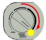
Bei der aktiven Verbrennungskalibrierungsfunktion ist es nicht möglich, mit dem Heizwassertemperaturwähler die Kesselleistunge (Gebläsedrehzahl) zu ändern, wie bei der Schornsteinfegerfunktion.
