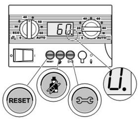
Während des Abgastestes können Sie den Heizkessel mit reduzierter Kesselleistung betreiben (z. B. zur Gasventileinstellung). Die Reduzierung gilt nur für die Dauer des Abgastestes.
