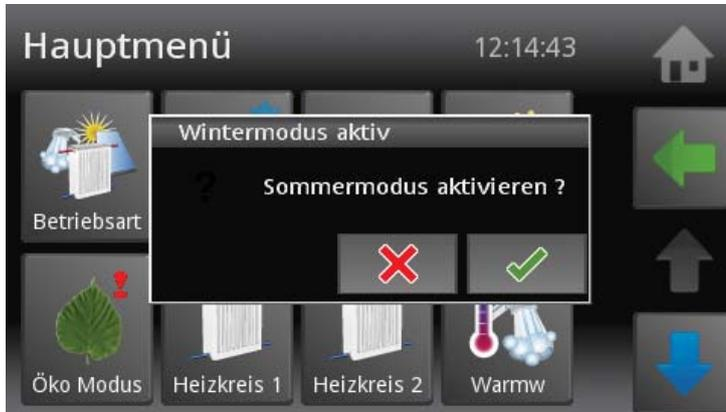
Die Anlage schaltet vom Warmwasserbetrieb in den Heizbetrieb und umgekehrt.
