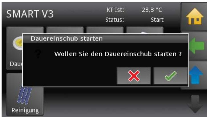
Der Brennermotor läuft im Dauerlauf für 9 Minuten und transportiert Pellets zum Brennteller.
