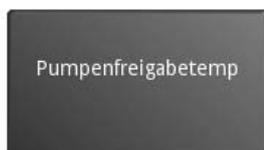
Die Warmwassertemperatur muss höher als die **Pumpen-Freigabetemperatur** sein, ansonsten schaltet die Zirkulationspumpe nicht ein.
