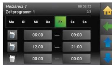
**8** Mit ↑ and ↓ wechseln Sie zwischen den Heizblöcken. Sie können auch im Nachhinein Heiztage im Heizblock deaktivieren und in einem anderen aktivieren.
