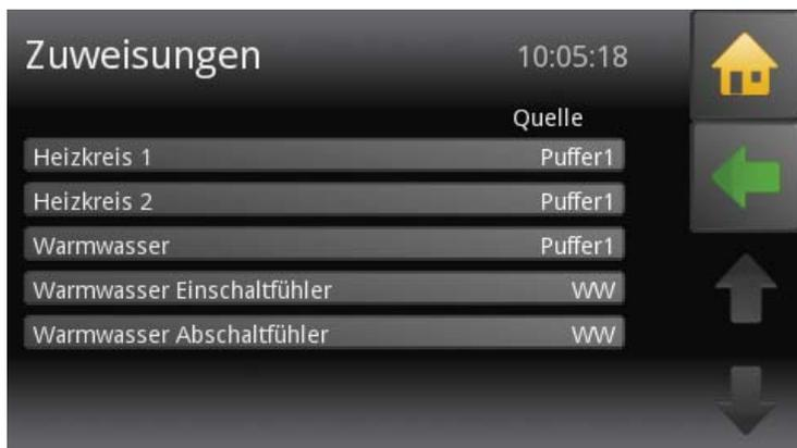
Im Menüpunkt **Zuweisung** sehen Sie, welche Heizkreise und das Warmwasser dem Kessel oder Puffer zugewiesen sind.
