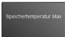
Wenn die Temperatur im Speicher höher ist als die **Speichertemperatur-Max**, schaltet die Solarkreispumpe ab. Der Begrenzungsfühler misst die Temperatur im Speicher.
