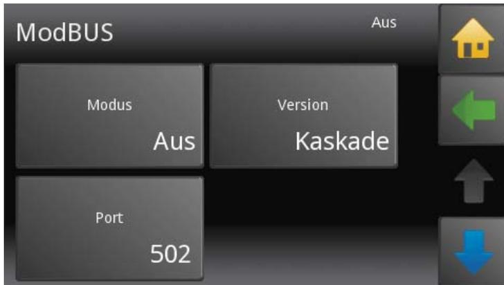
Das **ModBUS-Protokoll** ist ein Kommunikationsprotokoll, das auf einer Master / Slave- bzw. Client / Server-Architektur basiert.
