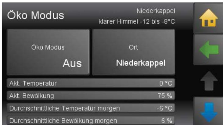
Mit dem Öko Modus kann der Einfluss der Wettervorhersage definiert werden. Wird Sonnenschein erwartet, wird die Raumtemperatur bereits im Voraus automatisch abgesenkt. Dadurch kann bei Gebäuden, die sich bei Sonneneinstrahlung merklich erwärmen, eine Überhitzung der Räume vermieden und Energie eingespart werden.
