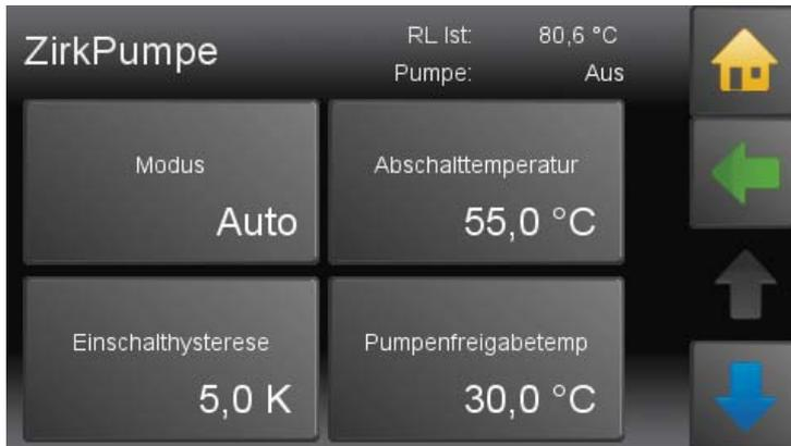
Die **Zirkulationspumpe** ermöglicht das sofortige Zapfen von Warmwasser an den Wasserhähnen. Zirkulationspumpe hat folgende Menüpunkte:
