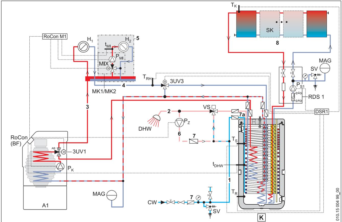
Bild 6-2 Standard-Anschlusschema mit A1-Brennwertkessel und Druck-Solar<sup>1)</sup> (Legende siehe Tab. 6-1)
