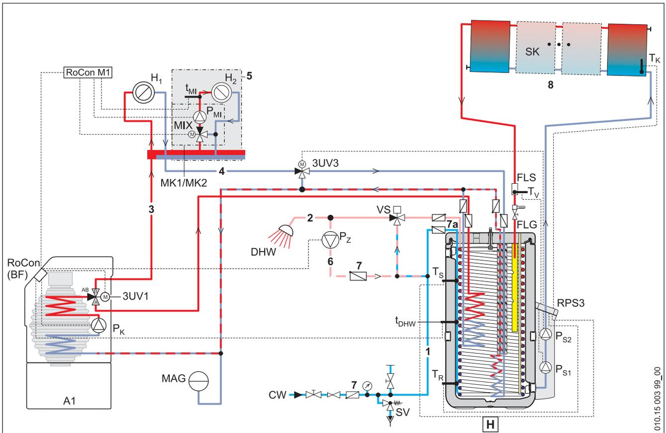
Bild 6-3 Standard-Anschlusschema mit A1-Brennwertkessel und drucklosem Solar DrainBack<sup>1)</sup> (Legende siehe Tab. 6-1)
