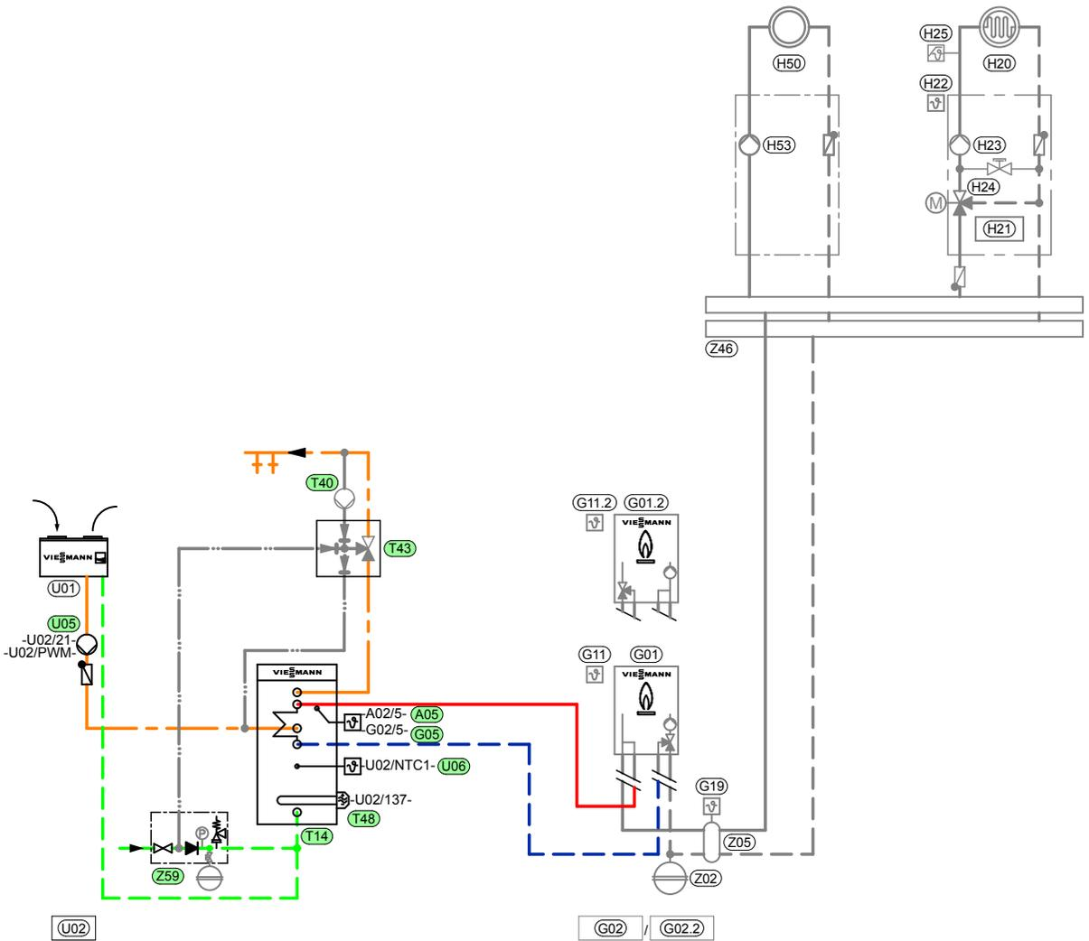
Variante 3: Vitocal 262-A, Typ T2W mit zusätzlichem Wärmeerzeuger (wandhängend/bodenstehend) und bivalentem Speicher-Wassererwärmer, Typ CVE (mit Ladelanze)
