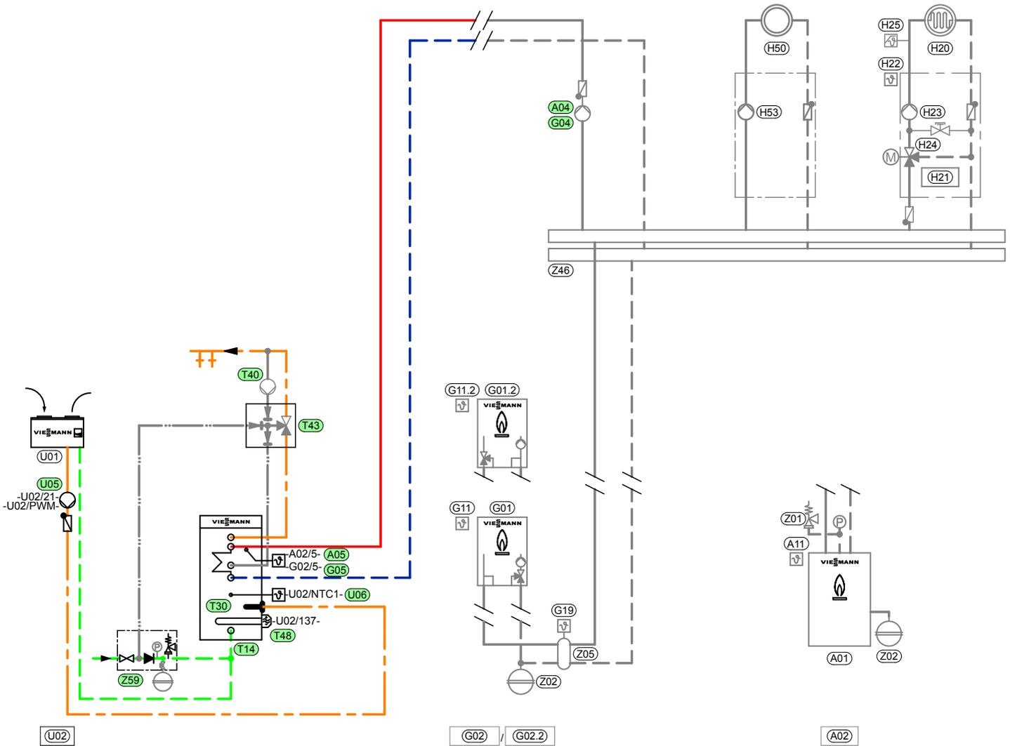
Variante 4: Vitocal 262-A, Typ T2W mit zusätzlichem Wärmeerzeuger (wandhängend) und bivalentem Speicher-Wassererwärmer, Typ CVE (mit Ladelanze)
