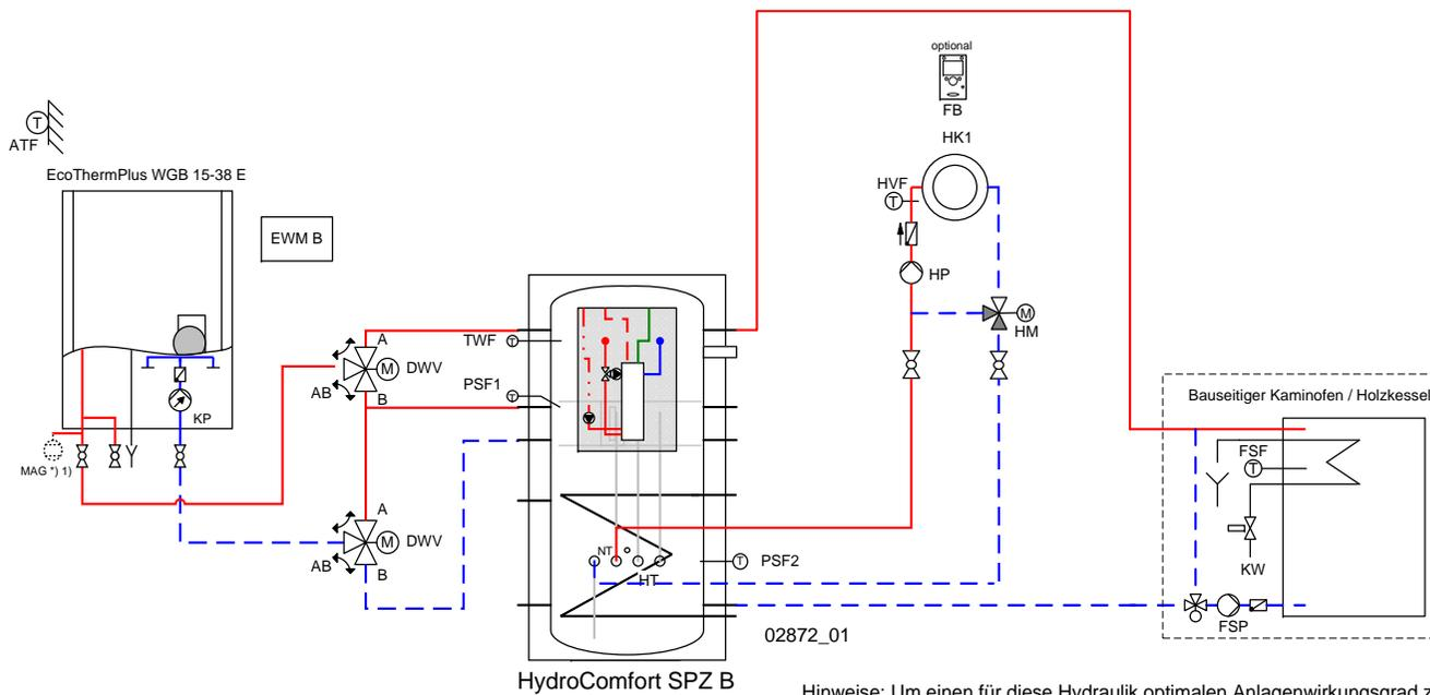
**Hinweis:** Beim Umschaltventil USV bzw. DWV... ist der Weg AB / B stromlos geöffnet
